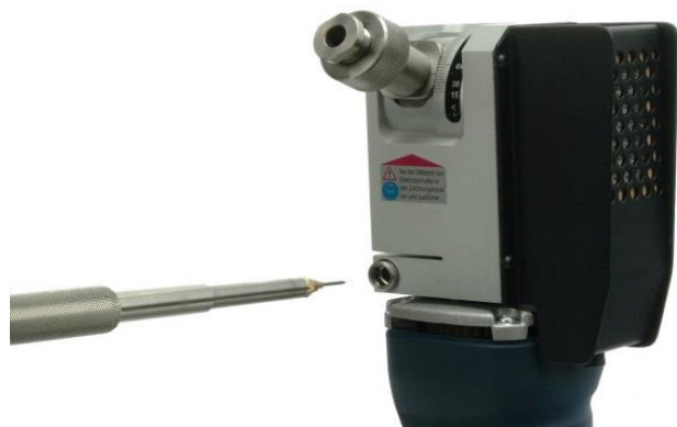
Kalibrace elektrody před broušením
