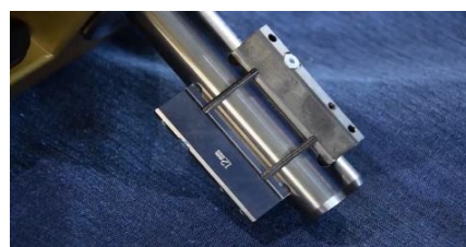
Krok 3 : Namontujte upínací čelisti na hřídel stroje.
