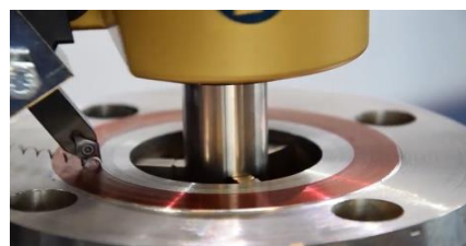
Krok 9 : Opracujte povrch příruby.
