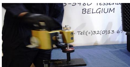
Krok 9 : Otáčením stroje opravujte povrch příruby.
