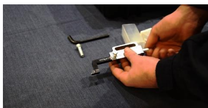
Krok 6 : Nasadte nástroj do držáku.
