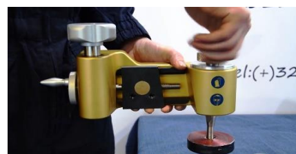
Krok 4 : Nasadte stroj na přírubu aby celá kleštinu byla pod rovinou příruby.
