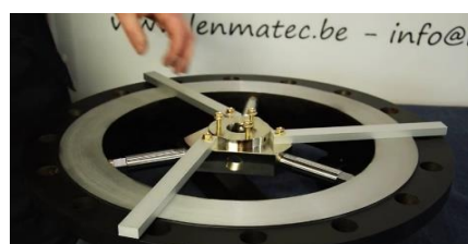
Krok 4 : Připevněte pravítka pro zajištění roviny a nasadte ústrojí.
