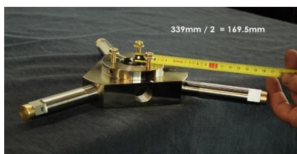
Krok 3 : Smontujte upínací ústrojí a nastavte správnou délku čelistí.
